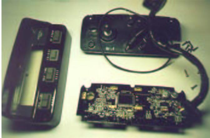
Auf den teilweise spröden, umlaufenden O-Ring der Gehäuseabdichtung achten, daß dieser nicht reißt.
